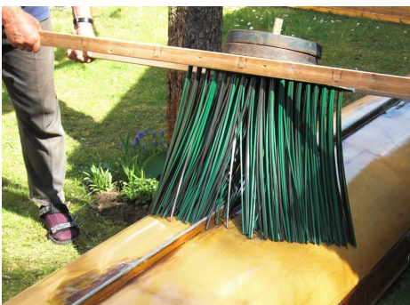
Kratzversuche im Trocknen an einem C-Gig-Zweier
