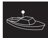
Maschinen- unter 7 m (max. 7 kn) bzw. Segelfahrzeug (auch unter Ruder) unter 12 m Länge, wenn andere Lichter nicht geführt werden können
